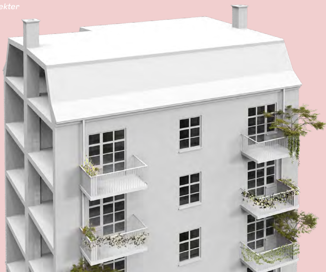
Altankasse med kapillærvanding. Rendering: Mads Lützen - Lützen arkitekter
